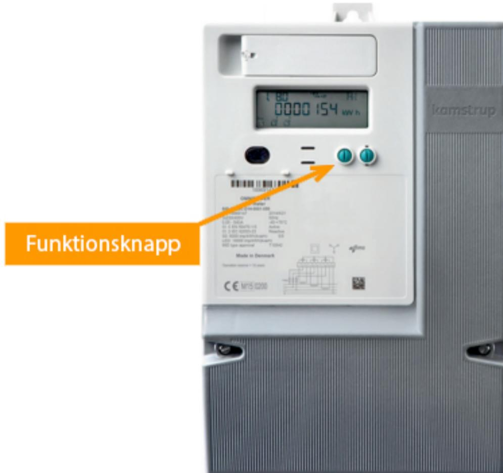
**Startläge: Mätarställning på den totala förbrukningen Aktiv energi i kWh.**
